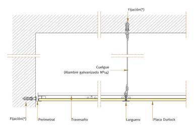
NOTA: \* Para la fijación de los Cuelgues a la losa se utilizarán tarugos de nylon con tope N°8 y tornillos de acero de 6mm de diámetro x 40mm, o brocas metálicas
